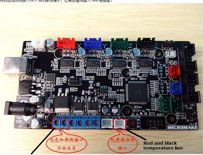
将白色加热线接入HOT BED接线端子,红黑感温线插入TB牛角插座。
